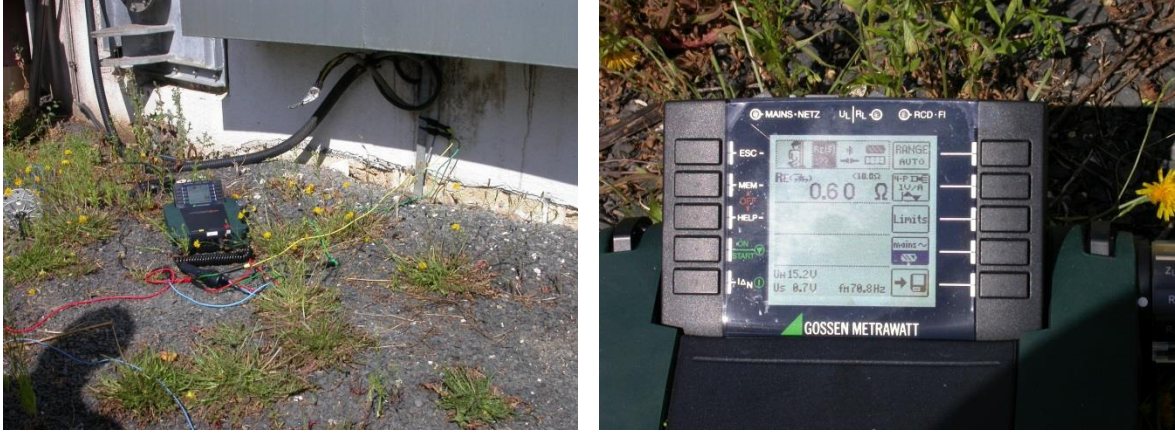
Şekil 6: PROFITEST MXTRA ile 4-Telli Ölçüm Methodu
