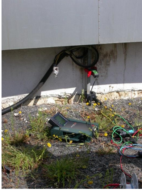
Şekil 7: Profitest MXTRA ile toprak çevrim direnci ölçümü
